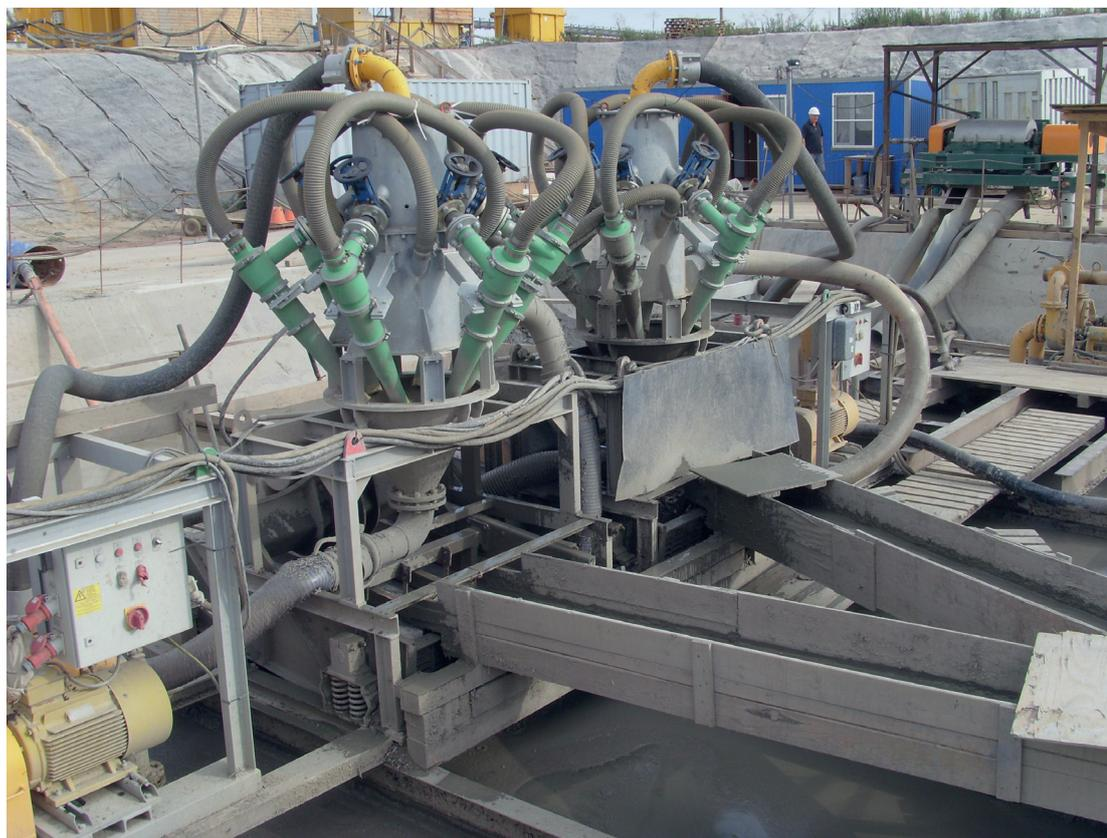
Anlage zur Abscheidung von Sand aus der Bohrspülung
