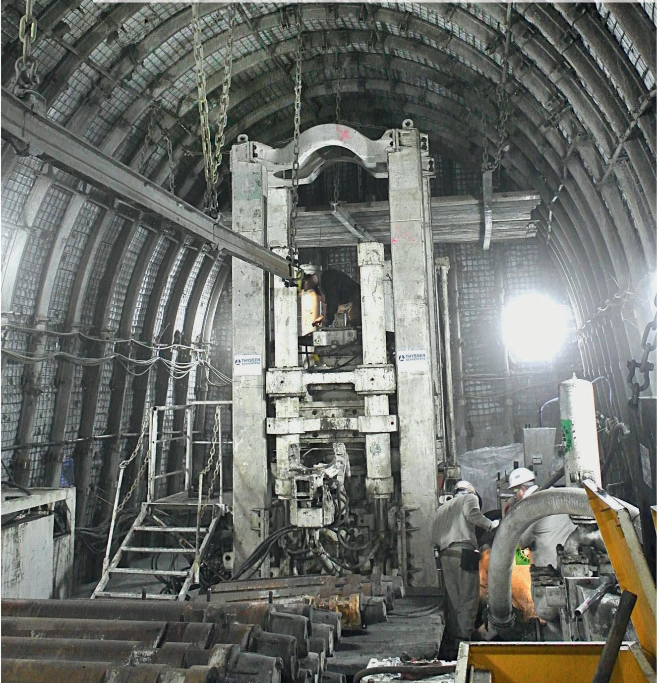
Raisebohranlage HG 250 in der Bohrkammer I 547
