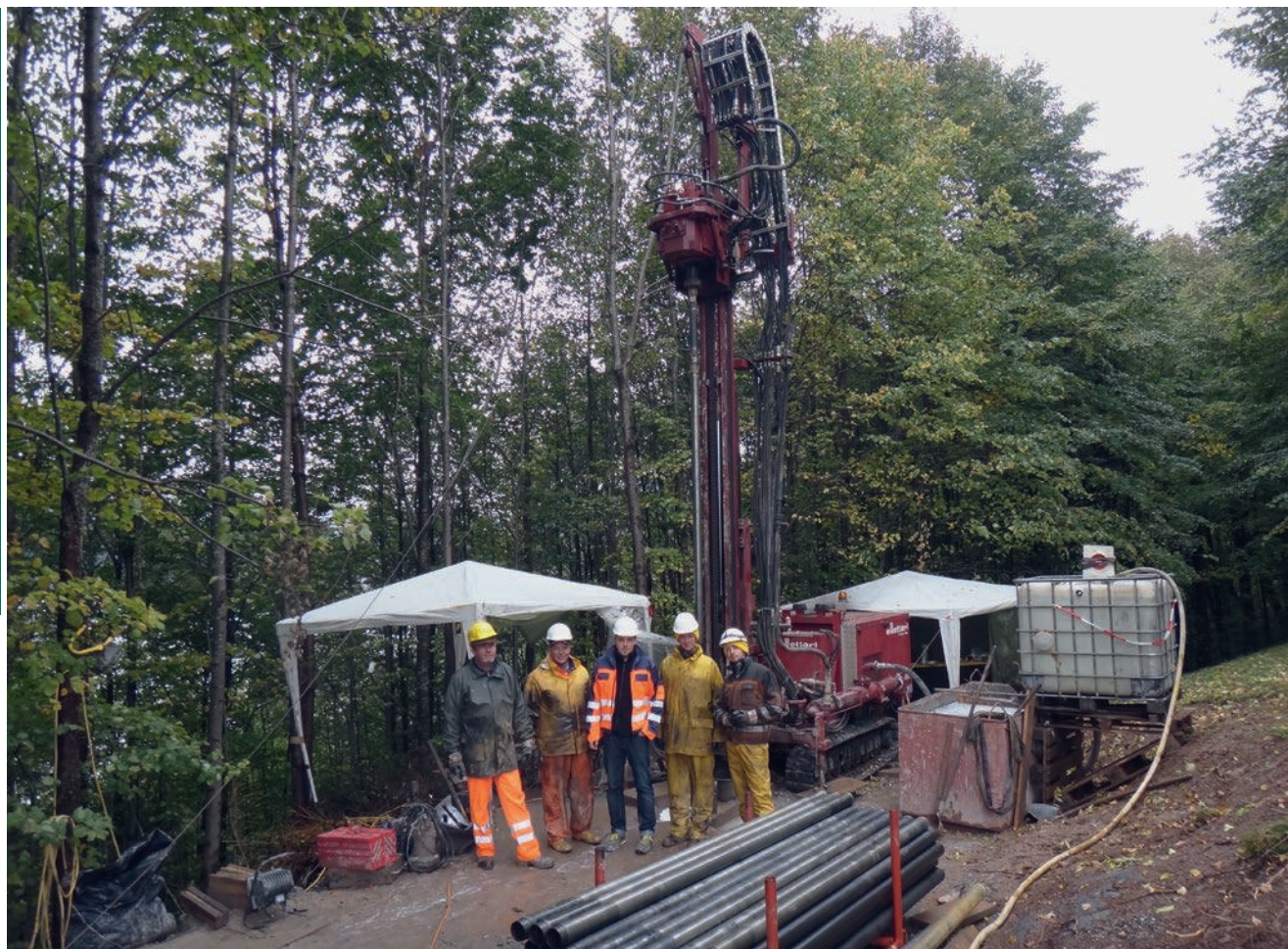
Буровая площадка для разведочной скважины глубиной 300 метров в сложных топографических условиях
